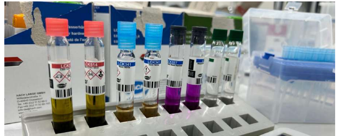
Analyse der Parameter CSB, Nitrit, Wasserhärte und Nitrat (v. l. n. r.) im Labor mittels Küvettentests
