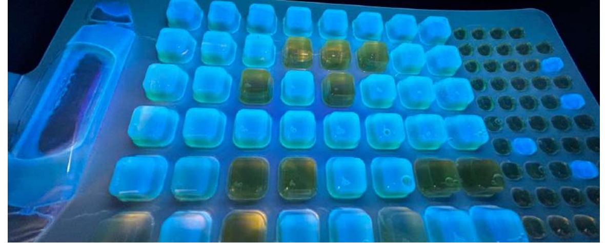
Analyse von gesamtcoliformen Bakterien und E-Coli im Rohgrauwasser mittels IDEXX-Verfahren
