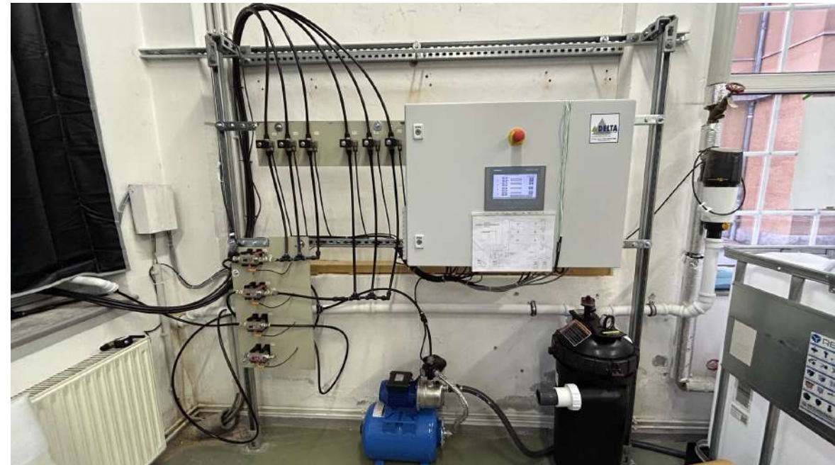
Speicherung des Grauwassers und Steuerung der Versuchsanlage
