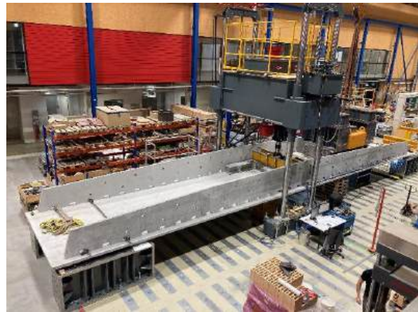
Abbildung 4 CPC Trogbrücke „Optima“ 17x3m unter Belastung, Quelle Holcim (Deutschland) GmbH
