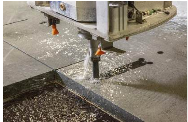
Abbildung 2 Ausfräsung in einer CPC Maßplatte, Quelle Holcim (Deutschland) GmbH
