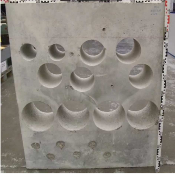
Bild 13: Bohrkernentnahme zur Herstellung von Probekörpern und durchgeführter Rückprall/Haftzugprüfung
