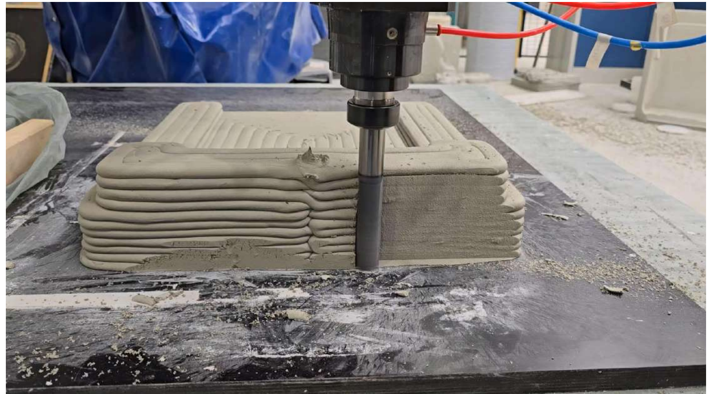
Fräßen des endkonturnahen additiv gefertigten Probekörpers im frischen Zustand
