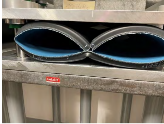
Bild 16: kollabiertes Verbundrohr außen gewellt, schwarz, innen glatt, blau (271,623 kg) Zusammenbruch nach 5.476 h
