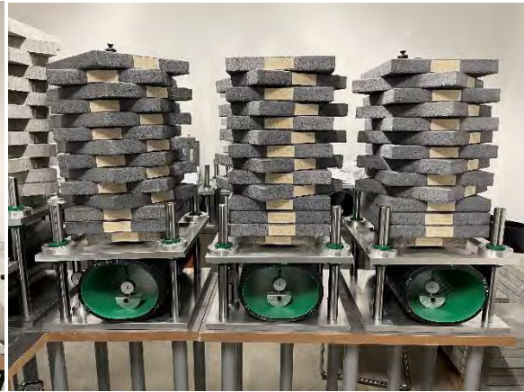
Bild 13: Belastungsende nach 10.000 h (267,314 kg)
