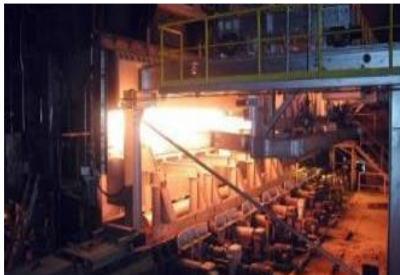
Stoßofen, Stahlwerk Thüringen
