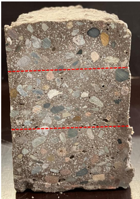
Bild 7: Schnittbild von 3D-gedruckter Probe
