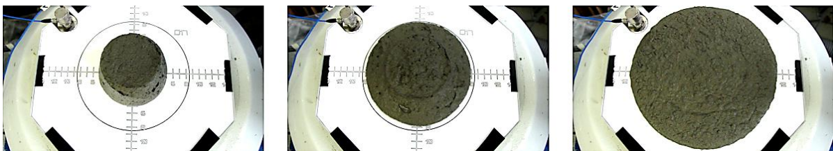
Bild 1: Ausbreitverhalten eines Betongemenges auf dem modifizierten Schwingprüfstand
