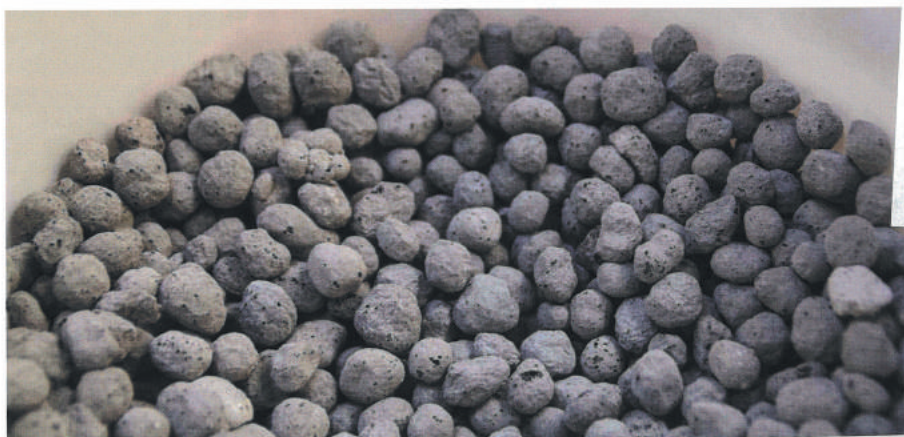
Im Forschungsprojekt ersetzen die recycelten Granulate den Bims als Gesteinskörnung für den Leichtbeton. Fotos: Thimo Hennig/IAB Weimar gGmbH
