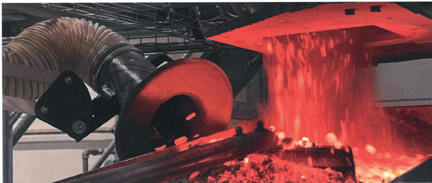
Bau- und Abbruchabfälle werden im Drehrohrofen zu Granulaten gebrannt. Das Verfahren ähnelt der Blähton-Herstellung.
