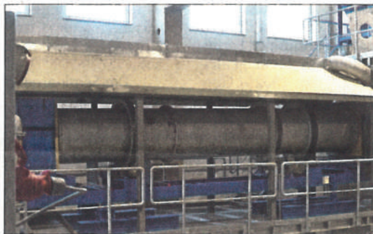
Herzstück des neuen Baustoffrecycling-Technikums des IAB ist dieser Drehrohr-Ofen. FOTO: SUSANNE SEIDE
