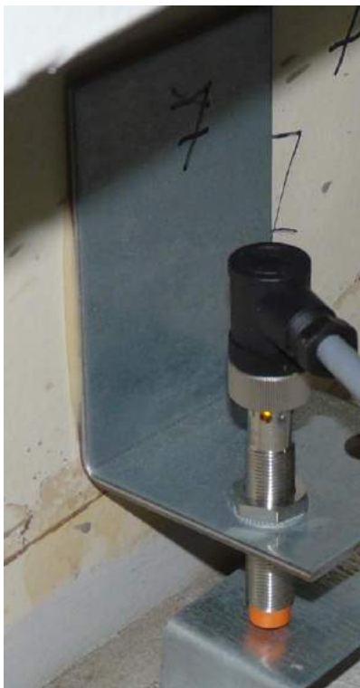
Bild 4: Distanzsensor an geklebter Halterung
