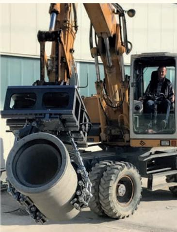
Nutzung des Fin Ray Effektess® für einen Rohrverlegegreifer
