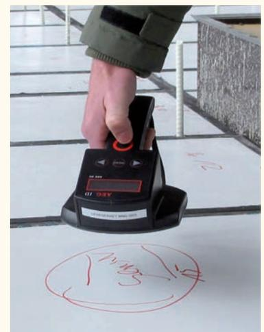
Prüfung der Dichtigkeit von VIP-Elementen
