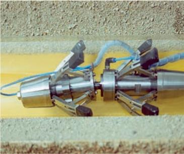
Analyse von schwer zugänglichen Rohrleitungen: Rohrraupe mit Sensortechnik
