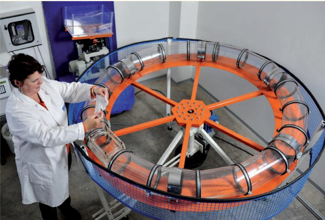
Entwicklung innovativer Versuchsstände für spezielle Untersuchungen: Endless Sewer zur Untersuchung der Zerfallskinetik von Vliesstoffen
