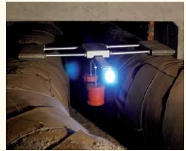
Inspektion von nicht begehbaren Fernwärmekanaln mit der Kanalspinne
