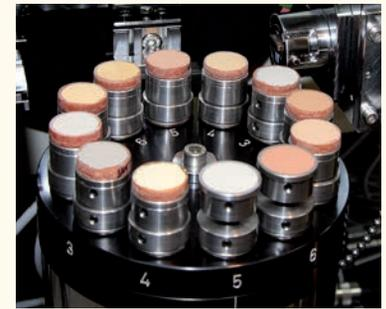
Probenwechsler des Multi-Röntgendiffraktometers
