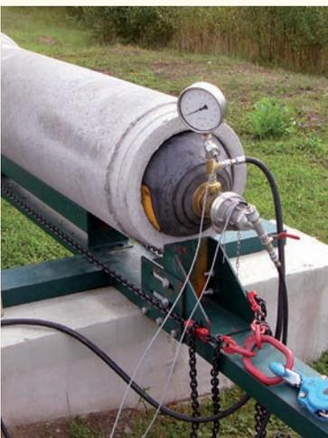
Druckversuche an einem Stahlbetonrohr
