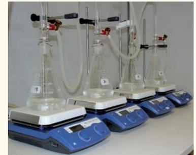
Versuchsaufbau zur Bestimmung der Puzzolanität von Meta-Tonen
