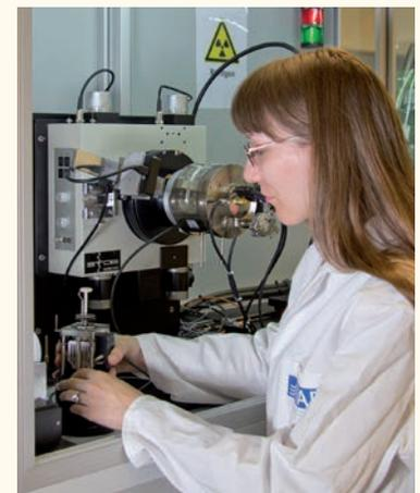
Analyse der mineralogischen Zusammensetzung pulverförmiger Präparate mit einem Röntgendiffraktometer
