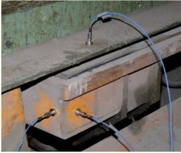
Schwingungsmessungen für Maschinendiagnosen
