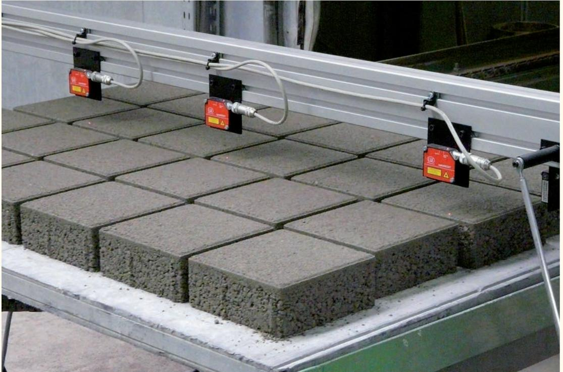
Qualitätsüberwachung bei der Herstellung von Betonwaren mit einer Anlage zur Steinhöhenmessung, die modular zur Rohdichteermittlung erweitert werden kann
