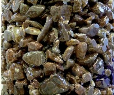
Verbesserung von wenig tragfähigem Baugrund durch polymergebundene Schottersäulen
