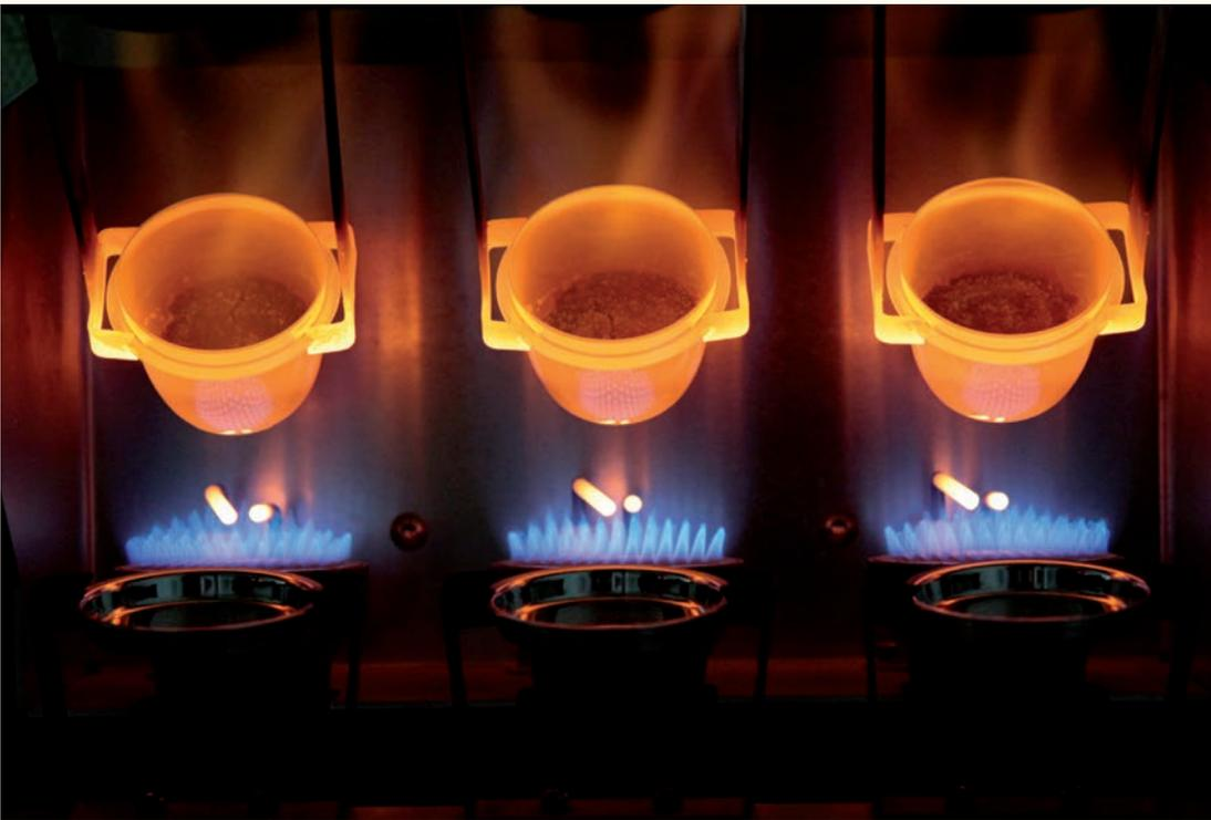
Herstellung von Schmelztabletten für die Röntgenfluoreszenz-Analyse: Die zu untersuchenden pulverförmigen Stoffe werden mittels Schmelzsatz bei 800 – 900 °C zu transparenten Glasscheiben geschmolzen
