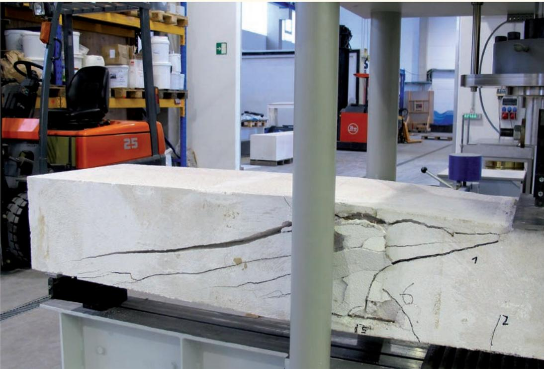
3-Punkt-Biegezugversuch an einem Leichtbetonelement
