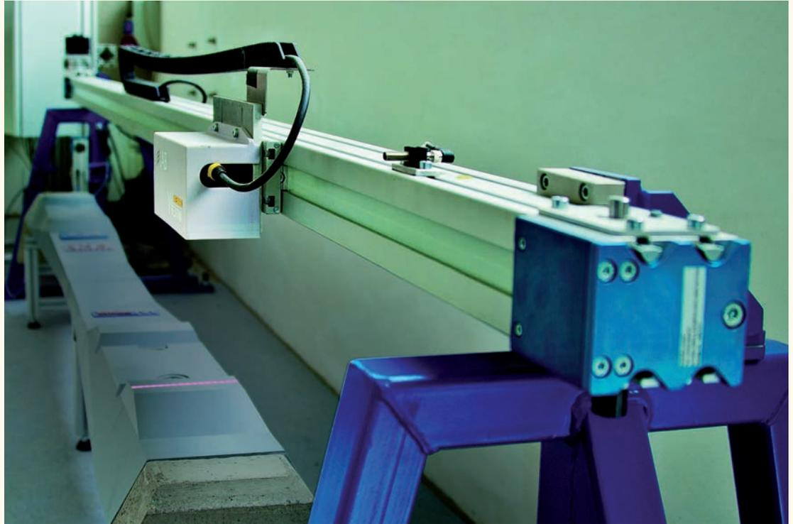
Einrichtung zur automatisierten Qualitätsüberwachung der Lage der Spannbewehrung und Maßhaltigkeit an Bahnschwellen als 100-Prozent-Prüfung
