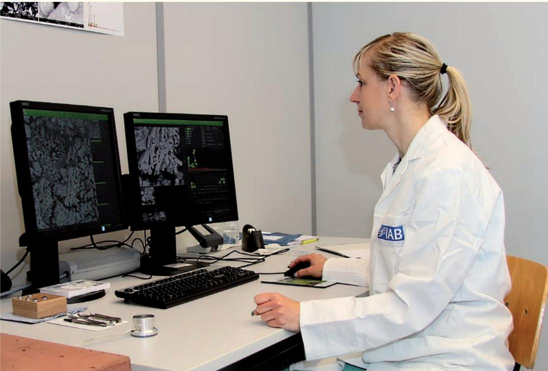
Strukturuntersuchung am Rasterelektronenmikroskop zur Bewertung der morphologischen Gefügeausbildung
