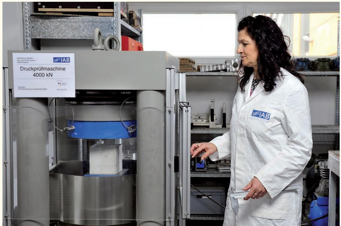
Druckprüfungen werden am IAB für die verschiedensten Baumaterialien durchgeführt
