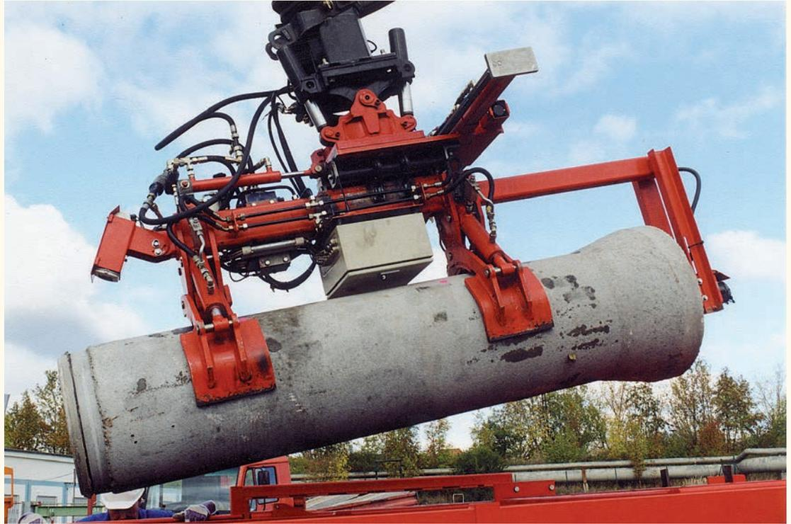
Die vollautomatische Rohrverlegemaschine ermöglicht ein sicheres Fixieren und Verlegen von Rohren ohne Personal im Rohrgraben und ersetzt damit aufwendige manuelle Arbeiten
