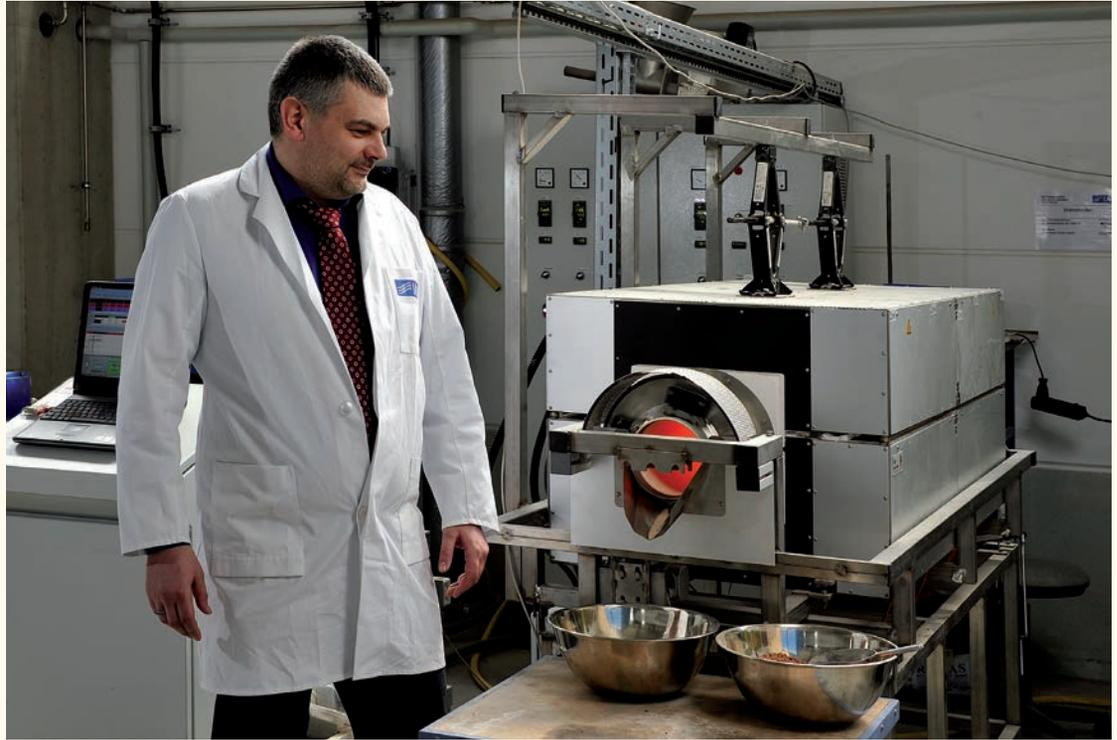
Mit dem Drehrohrföfen können verschiedenste Granulate im IAB hergestellt oder untersucht werden
